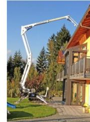
Maximale Tragfähigkeit der Bühne 200 kg
